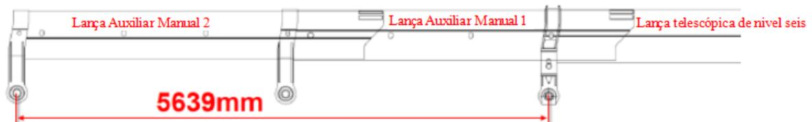
**Figura 19 Lança Auxiliar Manual 2**
